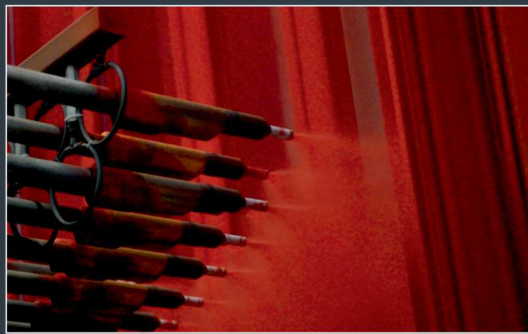
Impianto automatico di verniciatura verticale
